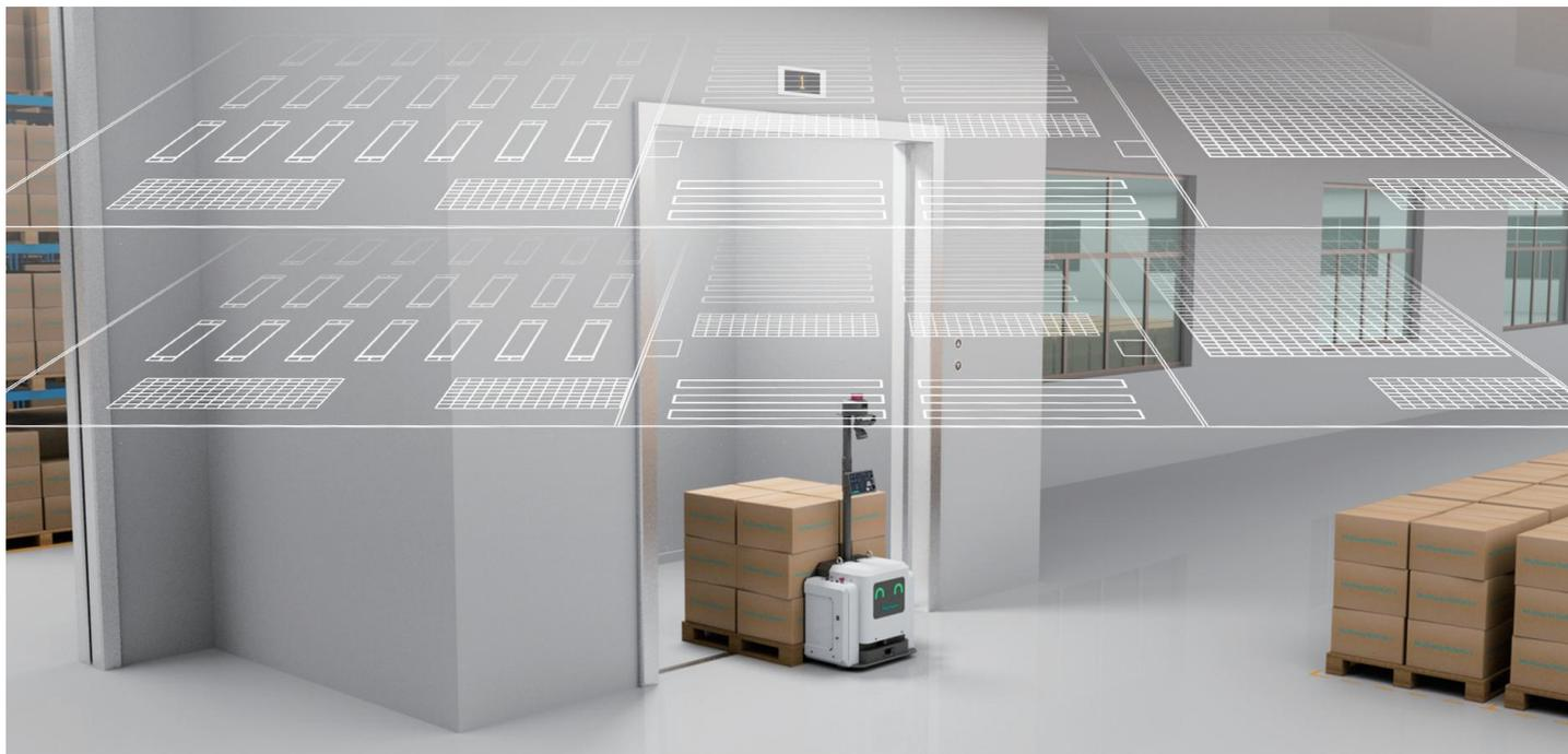
具备跨楼层搬运功能，满足多楼层、多区域的物料运输需求，通过设备控制系统MW-WCS自行与电梯或自动门进行信号交互，自动完成出入电梯、自动门等楼层转换和区域转运的动作。
